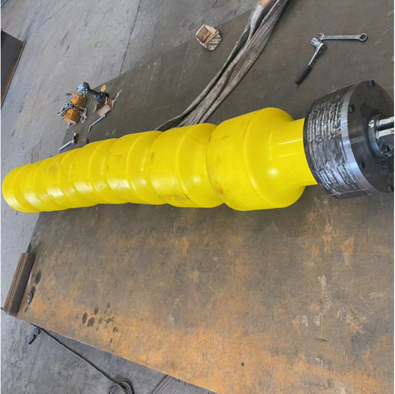
海缆中心夹具防脱装置
