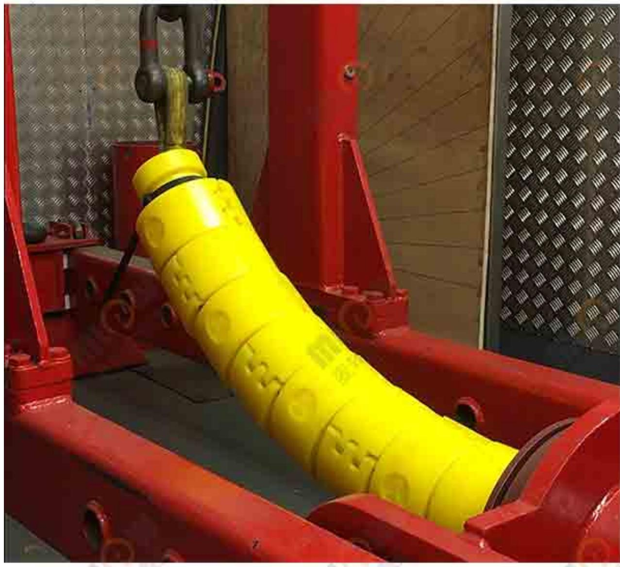
海缆弯曲限制器是麦轮聚氨酯专为海底电缆研发生产的一种防止过度弯曲、保护电缆结构的一款海工聚氨酯制品，聚氨酯独特的性能使聚氨酯限弯器具备刚性，广泛应用于海上风电、跨洋通信线缆保护等领域。
