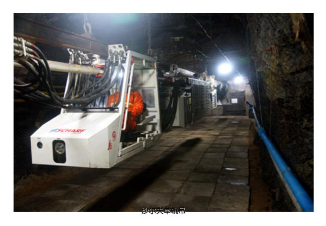
德国沙尔夫柴油单轨吊驱动摩擦轮轮芯材质采用铸钢为主,胎面是NDIthane 95 材料,柴油单轨吊胶轮具有防爆功能,承载应力好,耐磨性好,抗撕裂强度大,高摩擦系数和驱动,刹车效果好。
