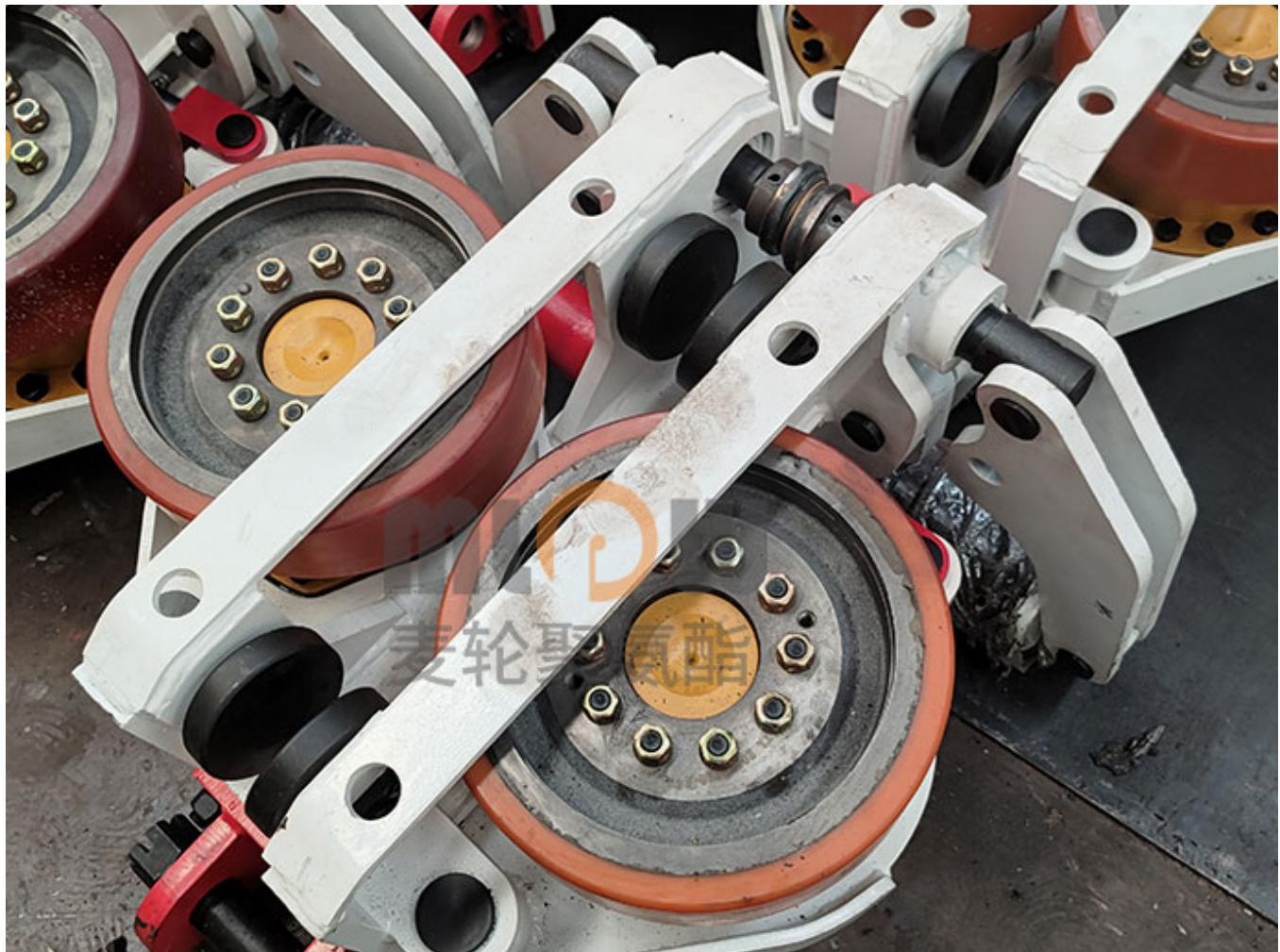
矿用单轨吊行走轮是矿山机械单轨吊驱动轮重要的驱动部件，矿用单轨吊行走轮,聚氨酯行走轮，矿山机械包胶轮的型号有340\*100、350\*90、350\*100、355\*95、400\*100、450\*97等，低内生热损耗小，使用寿命长。
