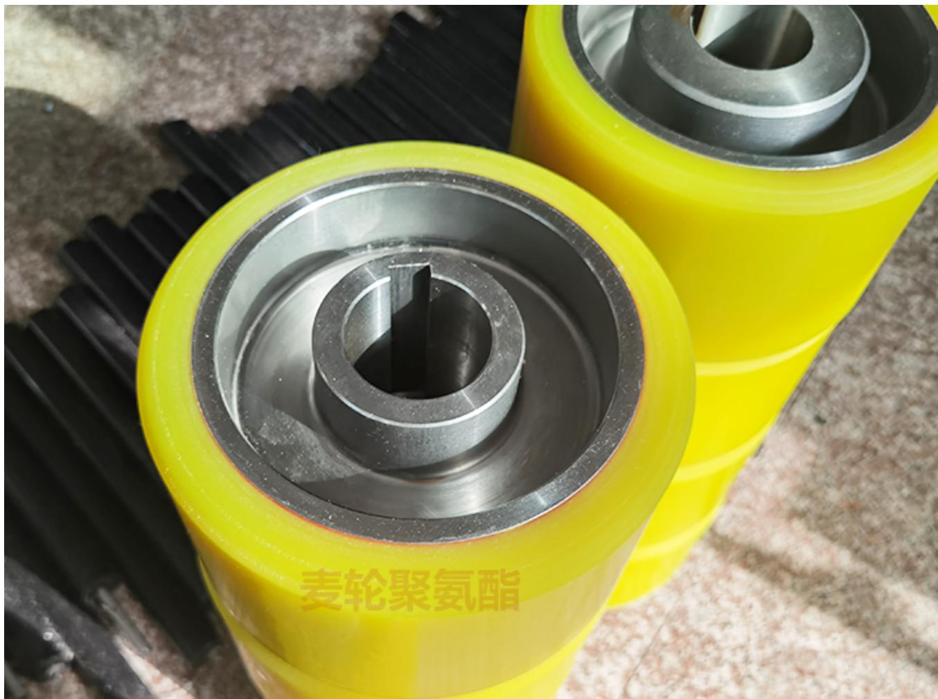
压铸铝合金包胶聚氨酯车轮，是AGV自动引导车常用的包胶轮系列，它耐多种腐蚀物质腐蚀，适用低温-30°高温+70°，硬度可达到93-95 Shore A噪音小，耐腐蚀等特性，广泛应用于仓储物流AGV小车，工厂搬运，食品加工等领域。
