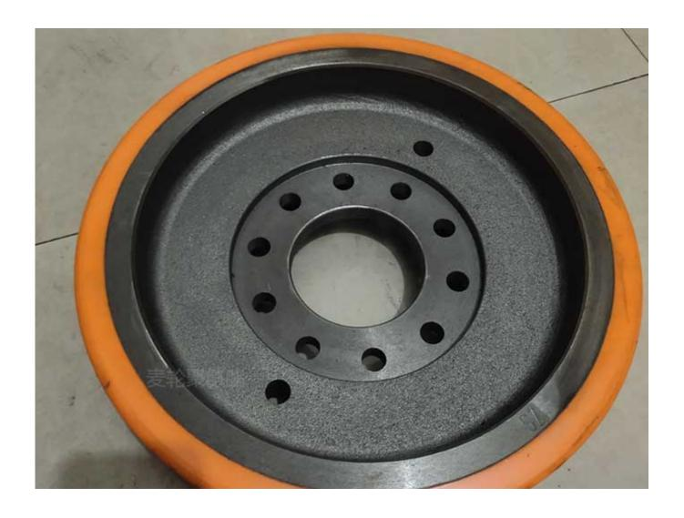
矿用单轨吊聚氨酯驱动轮的高度一致性可提供恒定的滚动摩擦力,从而降低滚动阻力。聚氨酯脚轮倾向于用比橡胶更硬的化合物制造。由于较硬的材料产生较低的滚动阻力,因此这也使聚氨酯车轮比橡胶车轮更易于操纵。
